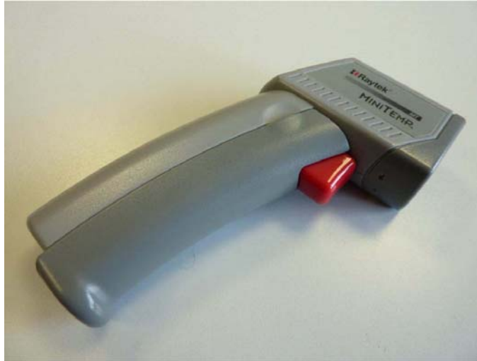
Abb. 2: Beispiel Laserthermometer, Raytek MiniTemp
