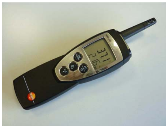
Abb. 1: Beispiel Messung RT, RL-Feuchte und Ermittlung der dazugehörigen Taupunkttemperatur, Testo 625
